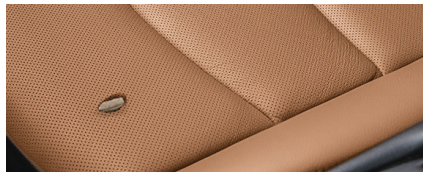
Trous dans le capitonnage
